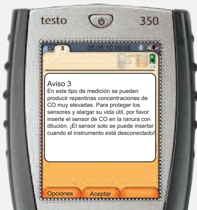
Detalle del visualizador de la unidad de control: función de diagnóstico e información en texto legible
