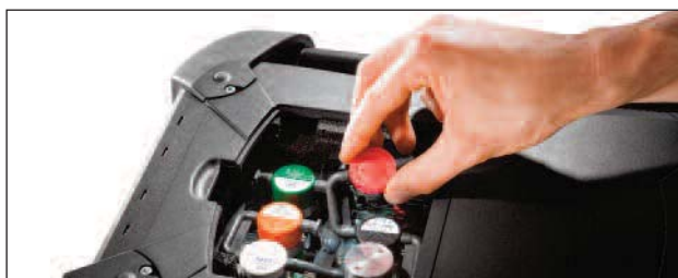
Plug & play: fácil reemplazo de los sensores
