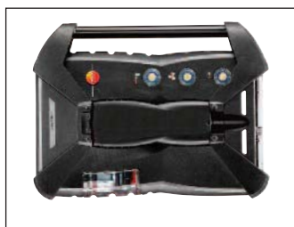
Unidad de control boca abajo: transporte seguro hasta la situación
