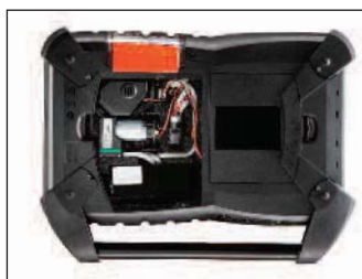
Tapa para el mantenimiento de las piezas susceptibles de desgaste
