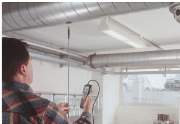
testo 416 p.ej. para ajustar la entrada de aire en una cocina
