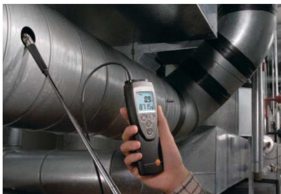
testo 416, p.ej. para controlar el caudal de salida
