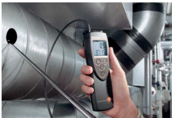
testo 425, p.ej. para controlar el caudal del aire de salida
