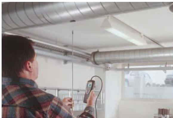
testo 425, p.ej. para ajustar la entrada de aire en una cocina
