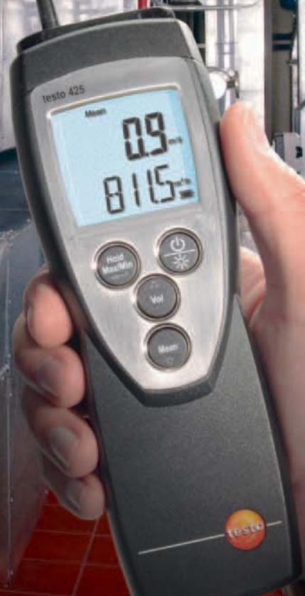
El anemómetro compacto testo 425 con sonda de velocidad y temperatura integrada y empuñadura telescópica.
